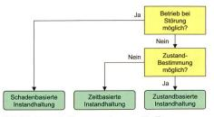
Bild 1. Beurteilungsschema für Baugruppen einer Steuerung.
