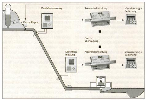
Bild 3. Anordnung der Elemente einer Druckschachtüberwachung.
