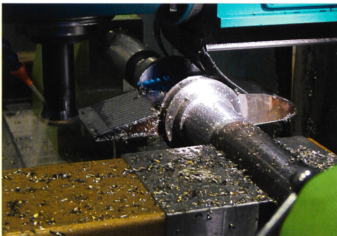
Bild 5. Bearbeitung der geschweissten Leitschaufel.
