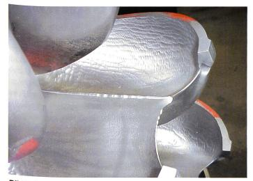
Bild 6. Schäden im Innern der Becher der Peltonturbine des Kraftwerks Kandergrund.
