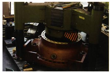
Bild 8. Ausdrehen des Schiebergehäuses.
