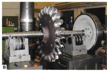
Bild 2. Auswuchten der rotierenden Teile der neuen Peltonräder: A) dynamisches, B) statisches Auswuchten.
