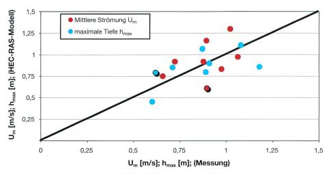
Bild 2. Gemessene und mittels HEC-RAS berechnete mittlere Fliessgeschwindigkeit  $(U_m)$  und maximale Tiefe  $(h_{max})$  in den aufgenommenen Querprofilen der Rhone. Die beiden Datenpunkte des Profils Riddes 1 sind durch Schattierung hervorgehoben.
