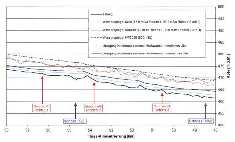
Bild 3. Längenprofil der tiefsten Sohlenlage (Talweg) und verschiedener Wasserspiegellagen der Rhone im Bereich der drei untersuchten Querprofile bei Riddes. Eingetragen sind auch die Einmündungen des Betriebswassers aus den beiden grossen Speicherkraftwerken Grande Dixence (Zentrale Nendaz) und Mauvoisin (Zentrale Riddes).
