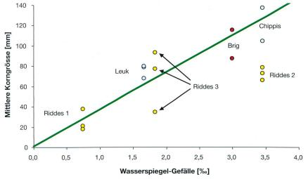
Bild 4. Mittlere Korngrösse des Substrates ( $d_{50}$ ) und Wasserspiegelgefälle in den untersuchten Querprofilen im Oberlauf (rot), Mittellauf (blau) und Unterlauf (gelb) der Rhone bei Sunk. Die Trendlinie ist grün dargestellt. Im Profil Chippis sind die dargestellten Punkte Einzelproben, in allen übrigen Profilen dagegen Mittelwerte aus je drei Einzelproben.
