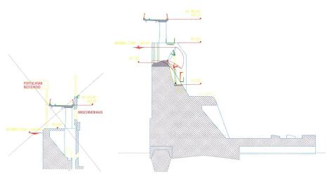
Bild 3. Schnitt durch die neue Wehröffnung mit Strassenbrücke.
