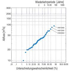
Bild 2. Frequenzdiagramm der Jahresmaxima der Glatt von 1948 bis 2002 beim Pegel Rümlang, Die Werte wurden unter Berücksichtigung der Verkrautung korrigiert.
