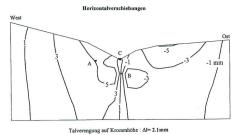
Bild 18. Resultat einer Berechnung mit dem Scheibenmodell: Verformungen.
