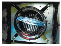
Bild 1. Empa-Gaschromatograph zur Analyse der halogenierten Treibhausgase.
