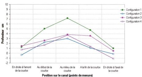
Figure 3. Affouillements en tête des épis selon les configurations pour un débit de 20 l/s.
