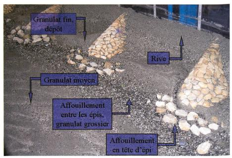
Figure 2. Visualisation des résultats des essais.
