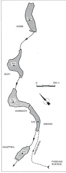
Bild 8. Fünf vom Stift St. Pelagius, Bischofszell, um 1430 erstellte Fischweiher in einem Tal bei Hauptwil mit Angabe der Meereshöhe der Stauspiegel (aus Schnitter 1992).
