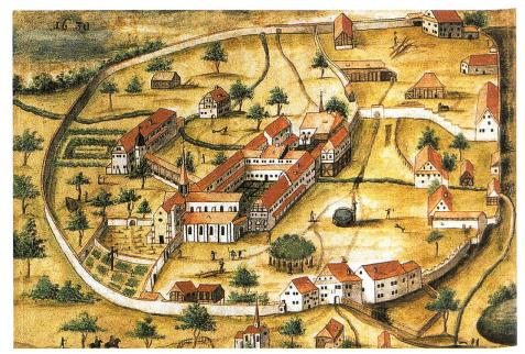
Bild 6. Aquarell der 1194 gegründeten Zisterzienserabtei St. Urban um 1630. Der kanalisierte Stempech tritt zweiarmig in die Klosterumfriedung ein (oben links), geht am Badhaus und dem Krankenhaus vorbei, unterquert im Klausurgebäude die Schlafsäle, den Speisesaal und die Küche und anschliessend ein Gewerbegebäude. Vor seinem Austritt aus der Klosterumfriedung treibt er eine Getreidemühle an. Oben links ist ein Mühleteich, unten rechts sind zwei Fischteiche zu sehen (aus Hörsch 1994).
