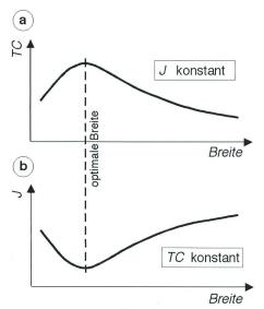
Bild 5. Transportkapazität (a) und Gleichgewichtsgefälle (b) in Abhängigkeit der Breite. Bei (a) sind Abfluss und Gefälle konstant, bei (b) Abfluss und Geschiebeeintrag.
