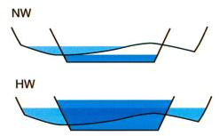
Bild 6. Wasserspiegellagen bei Niederwasser und Hochwasser in einem kanalisierten Gerinne und in einer Aufweitung.
