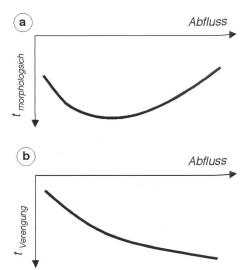
Bild 8. Kolktiefen in Abhängigkeit des Abflusses. a) Morphologischer Kolk  $t_{morph}$  im verzweigten Abschnitt, b) Kolk  $t_{\nu}$  bei der Verengung.
