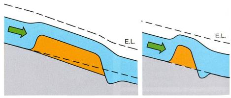
Bild 7. Geschiebedefizit und Sohlenerosion im Unterwasser durch die Ablagerung von Geschiebe in der langen Aufweitung (links). Kein Einfluss auf die Sohlenlage im Unterwasser durch eine kurze Aufweitung (rechts).
