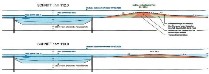
Bild 3. Schnitt durch den rechten Seitendamm bei hm 112 und hm 113.
