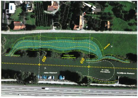
Bild 5. Massnahme 1 am mittleren Abschnitt beim Wendeplatz.
