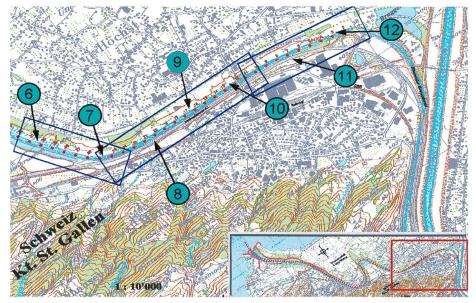
Bild 8. Übersicht über die Massnahmen in der freien Fliessstrecke.
