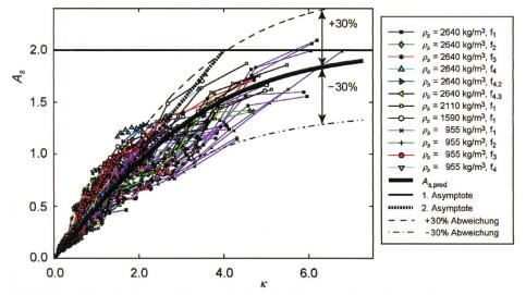
Bild 6. Normierte Wellenamplitude  $A_s$  in Abhängigkeit des dynamischen Rutschparameters  $\kappa$  und nach (——) Gleichung (6) angepasste Tangens-hyperbolicus-Funktion mit  $\pm 30\%$ -Abweichung von der mittleren Beziehung  $A_{s,pred}(\kappa)$  mit (——) 1. und (———) 2. Asymptote zu Gleichung (7a, b).
