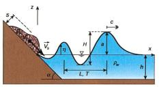
Bild 2. Definitionsskizze mit der Eintauchgeschwindigkeit  $V_s$ , der Rutschmächtigkeit s, der granularen Rutschdichte  $\rho_s$  und dem Rutschvolumen  $\forall_s$ , dem Rutscheintauchwinkel  $\alpha$  und den Wellencharakteristiken: Wasserspiegelauslenkung  $\eta$ , primäre Wellenhöhe H und Amplitude a, Propagationsgeschwindigkeit c, Wellenlänge L und Wellenperiode T, Ruhewassertiefe h und Dichte  $\rho_w$  von Wasser.
