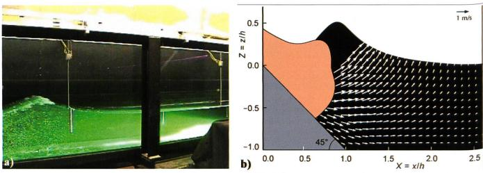
Bild 4. Impulswellenversuch bei F = 1,8,  $V_s$  = 3,1 m/s, h = 0,30 m,  $\rho_s$  = 955 kg/m³, s = 0,15 m,  $m_s$  = 39,7 kg,  $A_M$  = 0,45 und  $\alpha$  = 45°: a) Propagierende Solitärwelle im Wellenkanal und b) PIV-Geschwindigkeitsvektoren bei der Wellengenerierung.
