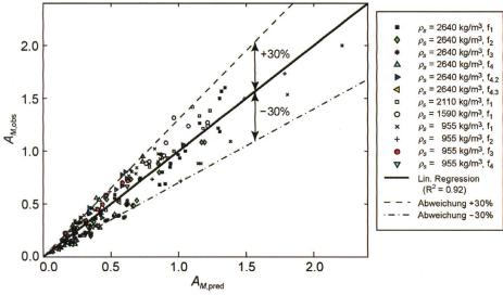
Bild 5. Vergleich zwischen gemessenen  $A_{\rm M,obs}$  und berechneten relativen Maximal-amplituden  $A_{\rm M,pred}$  der Primärwelle mit  $\pm$ 30%-Abweichung von der Regressionsgeraden nach (——) Gleichung (3) für verschiedene anfängliche Rutschformen  ${\bf f}_1, {\bf f}_2, {\bf f}_3, {\bf f}_4, {\bf f}_{4.2}, {\bf f}_{4.3}$  und granulare Rutschdichten  $\rho_{\rm s}$ .
