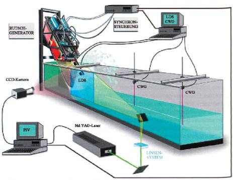
Bild 3. Schematischer Aufbau des 2-D physikalischen VAW-Modells mit dem pneumatischen Rutschgenerator, der Synchronsteuerungsanlage, den Laserdistanzsensoren (LDS), den kapazitiven Wellenpegeln (CWG) und Particle Image Velocimetry (PIV) mit dem Nd. YAG-Laser und der CCD-Kamera.
