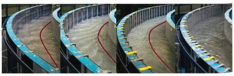
Bild 6. Abflussverhältnisse für verschiedene Rippenabstände (von links nach rechts: ohne Rippen, alle  $4^{\circ}$ ,  $2^{\circ}$ ,  $1^{\circ}$ ).
