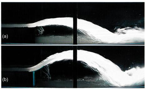
Bild 7. Einfluss vom Radius R auf die Strahltrajektorien für  $\beta$  = 40°,  $F_o$  = 5,  $h_o$  = 0,05 m und (a) R = 0,10 m, (b) R = 0,40 m.
