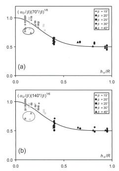
Bild 6. Relativer Absprungwinkel (a) oben  $(\alpha_o/\beta)(70^\circ/\beta)^{1/6}$  und (b) unten  $(\alpha_u/\beta)(140^\circ/\beta)^{1/6}$  in Funktion der Relativ-krümmung  $h_o/R$ .
