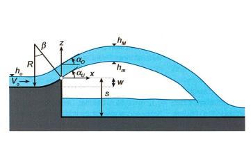
Bild 2. Definitionsskizze der Versuchsanlage mit den untersuchten Grössen.
