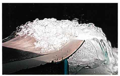
Bild 8. Strömungszusammenbruch bei abnehmendem Durchfluss (Q–), für R = 0,40 m,  $\beta$  = 40°.
