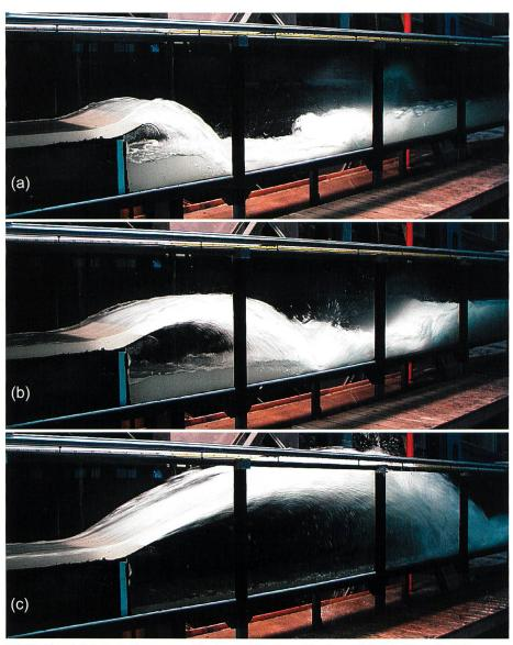
Bild 5. Vergleich zwischen verschiedenen Fliesszuständen mit R = 0,40 m,  $\beta$  = 30°,  $h_o$  = 0,05 m und  $F_o$  = (a) 3, (b) 5, (c) 10.
