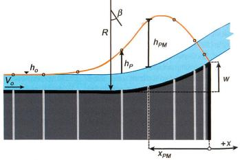
Bild 3. Definitionsskizze Druckkomponenten auf dem Flip Bucket.
