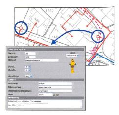
System 1: Hydrantenverwaltung mit hydroport, einem auf einer Datenbank basierenden Verwaltungsprogramm für die Inventur, Zustandserfassung, Bewirtschaftung und Planung von Hydranten und Armaturen für kommunale Wasserversorgungen
