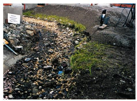
Bild 7. Uferschutz der Reuss bei Göschenen nach Belastung mit dem EHQ = 700 m<sup>3</sup>/s (VAW, 1994).
