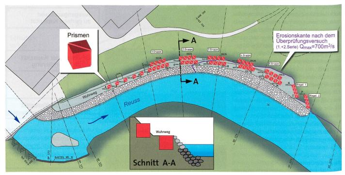
Bild 5. Uferverbauung der Reuss bei Göschenen (VAW, 1994).
