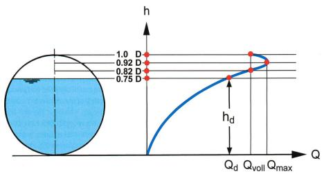
Bild 3. Abfluss im Kreisprofil in Abhängigkeit der Füllhöhe (Vischer und Huber, 2002).
