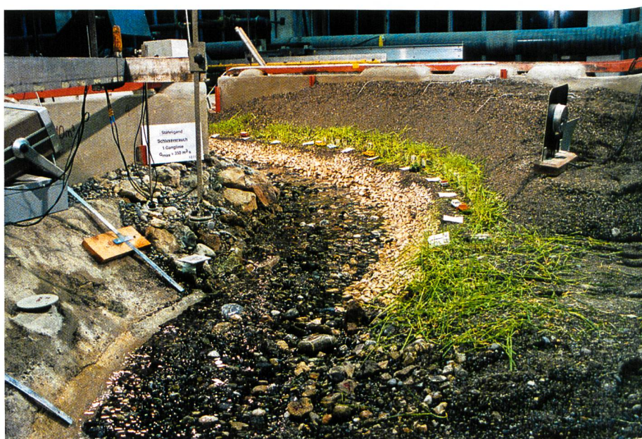
Bild 6. Uferschutz der Reuss bei Göschenen im Modellversuch nach Belastung mit Q_{50} = 380 \text{ m}^3/\text{s} (VAW, 1994).
