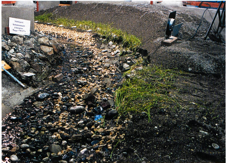
Bild 7. Uferschutz der Reuss bei Göschenen nach Belastung mit dem \text{EHQ} = 700 \text{ m}^3/\text{s} (VAW, 1994).
