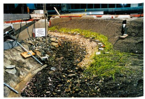
Bild 6. Uferschutz der Reuss bei Göschenen im Modellversuch nach Belastung mit  $Q_{50} = 380 \, m^3/s$  (VAW, 1994).
