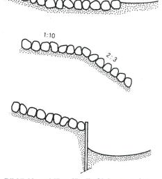
Bild 5. Vorschläge für die Sicherung des Rampenfusses, aus Whittaker und Jäggi, 1986.
