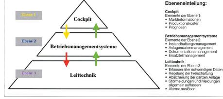
Bild 4. Management, Betriebsführung und Leittechnik in einer wissenbasierten Betriebsführung.
