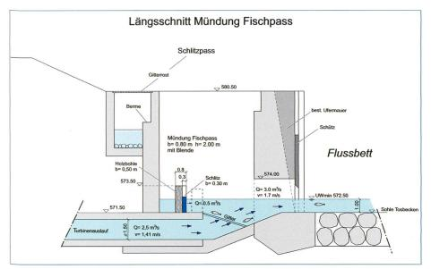
Bild 6. Längsschnitt durch den Mündungsabschnitt.
