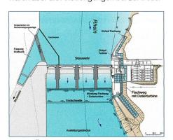
Bild 3. Übersichtsplan Wehr Reichenau mit Fischweg und Dotierturbine.
