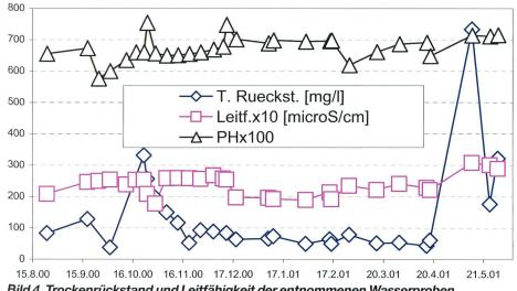
Bild 4. Trockenrückstand und Leitfähigkeit der entnommenen Wasserproben.
