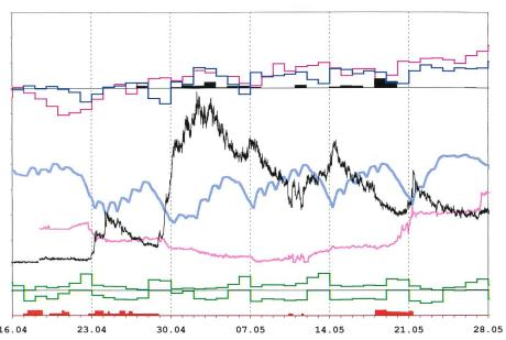
Bild 6. Ausschnitt aus Bild 5. Das Absetzen von Eismassen im Grimselsee auf Grund, erkennbar an reduzierten oder «negativen» Seezuflüssen (dunkelblaue Treppenlinie oben) bei sinkendem Seespiegel (blau), löste nach dem Wochenende vom 21./22. April 2001 und an den vier folgenden Wochenenden jeweils einen Anstieg der Trübung im Tiefenwasser aus (schwarz).
