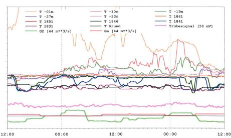
Bild 10. Temperaturverlauf über die Seetiefe vor der Spittellammsperre ab Mittwoch, 4. Oktober 2000, mittags (Skala von 5 bis 7 °C) sowie Trübesignal (mit Offset) und Abflüsse im Gelmerstollen (Ge) und Abflüsse im Grimsel 2 (G2). Die Skaleneinheit, d.h. der Abstand zwischen benachbarten Skalenstrichen, ist in eckiger Klammer angegeben.
