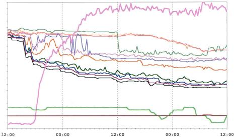
Bild 11. Temperaturverlauf vor der Spittellammsperre ab Samstag, 14. Oktober 2000, mittags (Skala von 4 bis 6°C), Horizontalachse unten: Trübesignal (mit Offset) sowie Abflüsse aus dem See und in Grimsel 2. Sondenpositionen und Skalen siehe Legende Bild 10.
