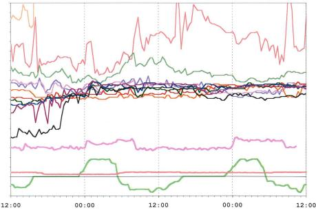
Bild 9. Temperaturverlauf vor der Spittellammsperre ab Dienstag, 24. August 2000, mittags (Skala von 4,5 bis 6,5 °C). Sondenpositionen siehe Legende Bild 10. Auf der Horizontalachse unten sind Trübesignal (mit Offset) und Abflüsse im Grimsel 2 sowie Abflüsse aus dem See aufgetragen (Skalen siehe Bild 10).
