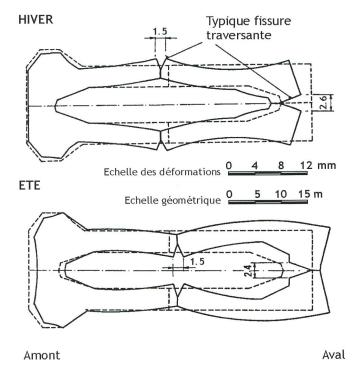
Figure 5. Section horizontale type du barrage à contreforts de Ancipa (Italie). Déformation de la structure et en fonction des conditions thermiques.
