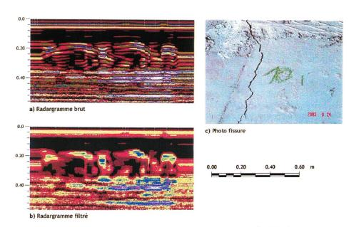
Figure 2. Images brute et filtrée de radar à très haute fréquence (1,5 GHz) d'une fissure du barrage de Pannecière, France (Image R3I).
