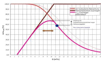
Bild 7. Erhöhung der Versagenswahrscheinlichkeit  $w_{100}$  durch Holztrieb und Geschiebe (braune Linie: absolute Wahrscheinlichkeit des Zuschlagens, violette Linie: kombinierte Wahrscheinlichkeit).
