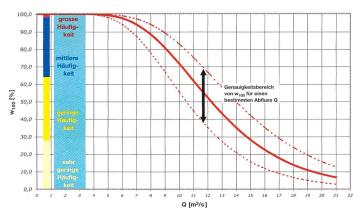
Bild 6. Qualitative Darstellung der Schätzgenauigkeit bei w<sub>100</sub> sowie Darstellung der Bereiche grosser, mittlerer, geringer und sehr geringer Häufigkeit (Farben gemäss Gefahrenstufendiagramm, mittlere Intensität).
