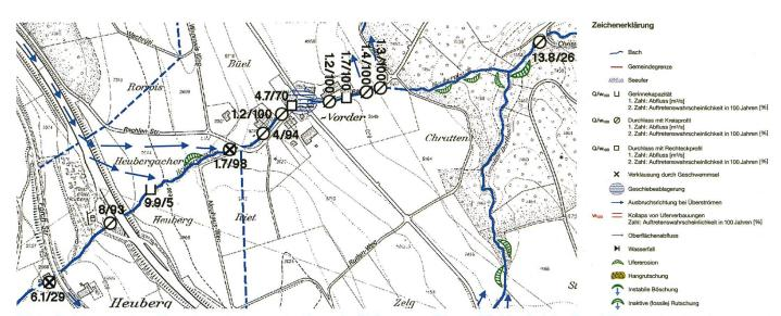
Bild 4. Gefahrenanalyse Maur, Ausschnitt aus der Karte der Phänomene. Die zwei Zahlen bei den Durchlässen oder einzelnen Gerinneabschnitten bedeuten die rein hydraulisch berechnete Durchflusskapazität und die entsprechende Auftretenswahrscheinlichkeit während einer Periode von 100 Jahren.
