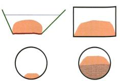
Bild 9. Die für den Geschiebetransport massgebende Einflusszone der Sohle für offenen Trapezquerschnitt, geschlossenen Rechteckquerschnitt, geschlossenen Kreisquerschnitt und für diesen der Fall von Teilfüllung mit Geschiebe. Je grösser der Anteil dieser Teilfläche am Gesamtquerschnitt ist, umso grösser ist die Geschiebetransportkapazität.
