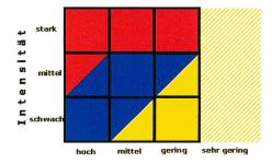
Wahrscheinlichkeit Bild 2. Gefahrenstufendiagramm gemäss BWW et al. 1997.
