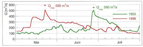
Bild 4. Tagesmittelganglinie der Limmat bei der Messstation Zürich Unterhard für die Hochwasserereignisse von 1953 und 1999.
