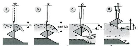
Bild 3. Typische Schützenstellungen s. a: Überströmen, b: maximales Überströmen bei einer abgespulten Kettenlänge von s = 160 cm, c: kombiniertes Über- und Unterströmen für 160 < s < 320 cm und d: Unterströmen. Ab s = ca.400 cm herrscht freier Wehrdurchfluss.
