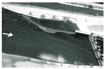
Bild 8. Blick auf die tiefen Kolke bei der Einlaufschwelle, entlang der linken Uferböschung und beim Wehrsporn nach Inbetriebnahme des Modells. Diese Kolklöcher haben sich in Natur – mit Ausnahme des Kolks beim Wehrsporn – nicht gebildet. Mit dem anfänglich gewählten Modell-Dispositiv kann die Sohlenlage in Natur nicht nachgebildet werden.
