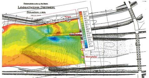
Bild 10. Überlagerung des Konturplots der Sohlenlage nach Inbetriebnahme des Modells (vgl. Bild 8) mit dem Situationsplan des alten Klappenwehrs. Die Kolke bildeten sich im Modell dort, wo in Natur Fragmente des alten Klappenwehrs und des Einlaufbauwerks liegen.
