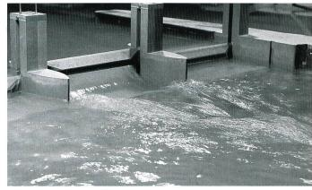
Bild 16. Links: Nach oben gerichteter Ausflussstrahl mit Deckwalze und kurzer welliger Übergang zum strömenden Abfluss. Rechts: Abflussverhältnisse vom 4. bis 13. Juni 1999: frei nach unten gerichteter Ausflussstrahl und kreuzende Stosswellen. In der Nachlaufströmung (Bild 17) bildet sich ein ondulierender Wassersprung. Solch «kleine» Wassermengen werden normalerweise durch Überströmen und nicht konzentriert durch ein Wehrfeld abgeleitet.
