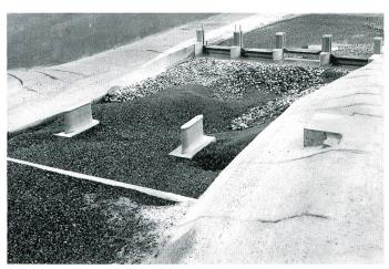
Bild 17. Ondulierender Wassersprung in der Nachlaufströmung von Wehrfeld 2 (links) sowie Sohlenlage (rechts) am 13. Juni 1999. In den Kolk rutschte die Blockschüttung nach.
