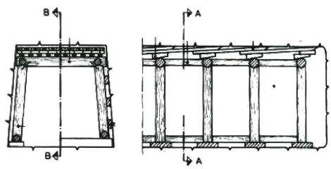
Bild 3. Schematische Darstellung der Marciavanti-Bauweise im Lockermaterial beim Bau des Stollens Anfang des 20. Jahrhunderts.
