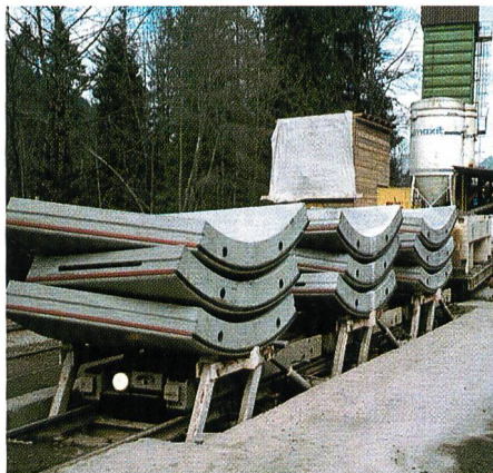
Bild 2. Zwischenlager für Stahlfaserbeton-Tübbinge.
