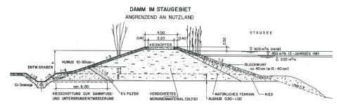
Bild 1. Längsdamm einer Stauhaltung – typischer Querschnitt mit Blockwurf, darunter liegender Filterschicht, verdichteter Moräne als Dichtung, Drainagekeil mit Filter geschützt und Drainagegraben.
