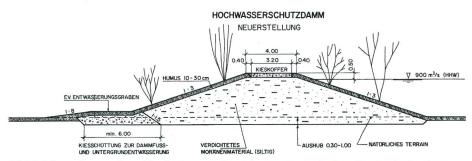
Bild 2. Längsdamm eines Hochwasserschutzdammes – typischer Querschnitt eines homogenen Dammes (kein Blockwurf, keine Filterzonen).
