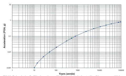
Bild 3. Seismische Gefährdungskurve für Stauanlage in Australien (Yarrawonga-Wehr, Bild: S. D. Fox).
