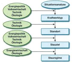
Bild 2. Darstellung der Optimierungsschritte für den Neubau Ruppoldingen.
