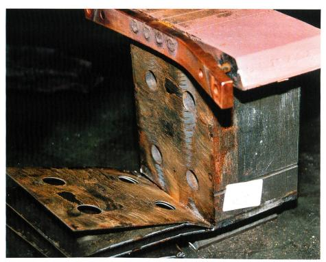
Bild 8. Durch Rost beschädigter Pol eines Generators.
