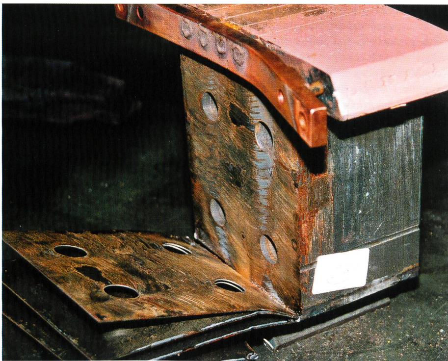
Bild 8. Durch Rost beschädigter Pol eines Generators.
