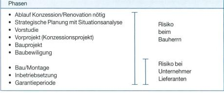
Bild 1. Phasen eines Projektablaufs für einen Kraftwerksneubau oder eine Kraftwerkssanierung mit zugehöriger Risikoverteilung.
