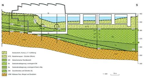
Bild 5. Schnitt durch den Untergrund entlang des Baukörpers des KW Ruppoldingen.
