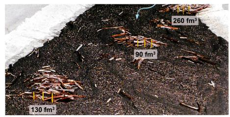
Bild 6. Holzrückhalt (fm3) mit verteilten Hindernissen im Modellversuch.
