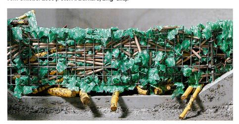
Bild 3. Verlegung eines Netzes im hydraulischen Modell; die grünen Stofflappen simulieren den Schwemmholzfeinanteil wie Laub oder kleine Äste (Blick gegen Fliessrichtung).
