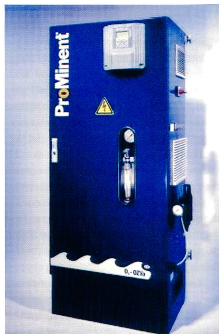
Bild 1. Neue Generation Ozonerzeugungsanlagen auf Sauerstoffbasis von ProMinent mit PSG-Technik. Sie gehören zur Baureihe OZONFILT® OZVa und decken den Leistungsbereich bis 30 g/h (100 g/Nm 3 ) in Bauart Wandschrank bzw. bis 60 und 90 g/h (100 g/Nm 3 ) als Standausführung auf Sockel ab.
