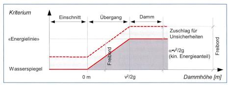
Bild 10. Mögliche Kriterien zur Festlegung der Abflusskapazität in Einschnitten und Dammstrecken (v: mittlere Fliessgeschwindigkeit, g: Gravitationskonstante, α: Korrekturfaktor).
