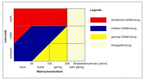
Bild 2. Intensitäts-Wahrscheinlichkeits-Diagramm (Gefahrenstufendiagramm, aus [2]).
