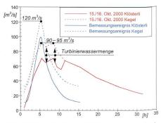
Bild 12. Vergleich von Abflussmenge und Dauer des Bemessungsereignisses mit dem Ereignis vom 15./16. Oktober 2000.
