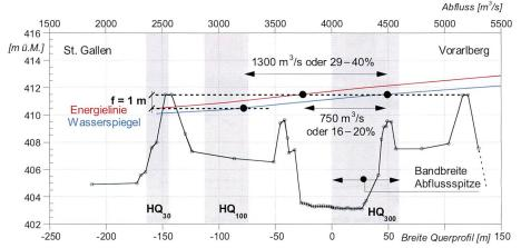
Bild 9. Abflusskapazität des Alpenrheins 10 km oberhalb des Bodensees im Querprofil km 79,4.
