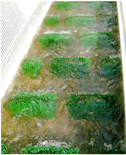
Bild 3. Abflussverhältnis in einem Borstenfischpass mit 8% Längsgefälle/200 l/s.
