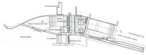
Bild 5. Wehranlage Au mit bestehendem Kanaleinlauf im Hintergrund, rechts Draufsicht.
