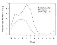
Bild 6. Vergleich der Abflüsse (m³s-¹) aus dem Schneespeicher zwischen Kontrollsimulation und Klimaszenario am Pegel Jonschwil.
