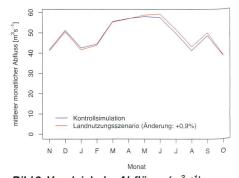
Bild 9. Vergleich der Abflüsse (m³s-¹) zwischen Kontrollsimulation und Landnutzungsszenario am Pegel Andelfingen.
