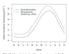
Bild 7. Vergleich der Verdunstung (m³s-¹) zwischen Kontrollsimulation und Klimaszenario im Teileinzugsgebiet Halden.
