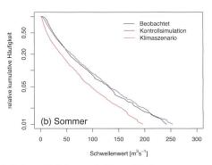
Bild 8. Relative kumulative Häufigkeit von täglichen Abflüssen: (a) Pegel Halden im Winter, (b) Pegel Halden im Sommer. Die kumulative Häufigkeit entspricht der Wahrscheinlichkeit, mit welcher der Schwellenwert überschritten wird.
