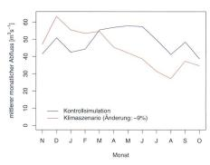
Bild 5. Vergleich der Abflüsse (m³s-¹) zwischen Kontrollsimulation und Klimaszenario am Pegel Andelfingen.
