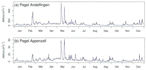
Bild 2. Berechneter (schwarz) und gemessener (blau) Abfluss (m³s⁻¹) für das Hochwasserjahr 1999: (a) Pegel Andelfingen, (b) Pegel Appenzell.
