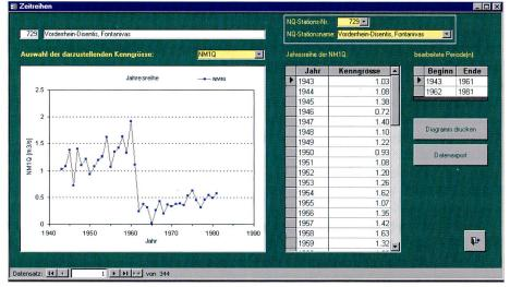
Bild 3. Formular «Zeitreihen» der Niedrigwasser-Datenbank NQStat. Als Beispiel wurde die Station 729 (Vorderrhein-Disentis, Fontanivas) gewählt, welche sowohl einen positiven Trend als auch einen Sprung in der Datenreihe der NM1Q aufweist (Beeinflussung durch den Stausee «Lai da Nalps» ab 1961).
