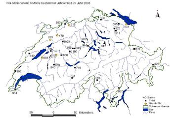
Bild 6. Jährlichkeiten der NM30Q-Werte ausgewählter Abflussmessstationen von Mai bis September 2003. Die Zahlen geben die Stationsnummer an.
