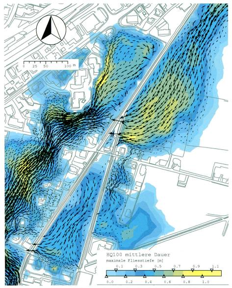
Bild 10. Berechnete Flussvektoren und maximale Fliesstiefen für ein 100-jährliches Niederschlagsereignis mittlerer Dauer.
