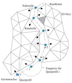
Bild 4. Automatisches Bestimmen der Nahtstelle zwischen 1D- und 2D-Modellen.
