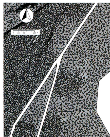
Bild 8. Modell Chisebach (Ausschnitt Konolfingen mit Abzweiger Gewerbekanal): Berechnungsnetze des 2D-Modells mit Aussparung für den Gerinneschlauch und Netzverdichtung im Siedlungsgebiet.
