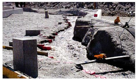
Bild 2. Gamsamodell im Bereich der Société Suisse des Explosifs für einen Abfluss von 82 m³/s.
