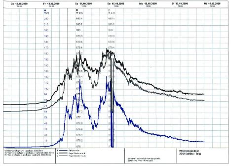
Bild 4. Abflussganglinie der Messstation Saltina, Brig, mit zwei Abflussspitzen am Vormittag des 14. und 15. Oktober 2000.
