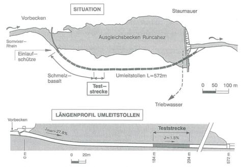
Bild 1. Lage des Umleitstollens, aus Jacobs et al.
