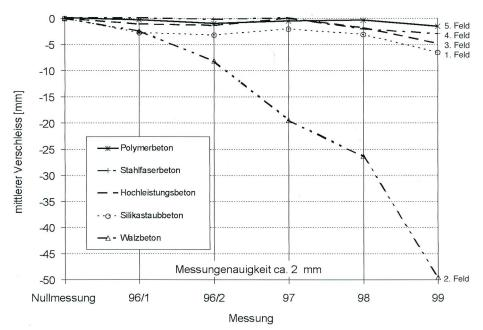
Bild 3. Gemessener mittlerer Verschleiss der fünf Versuchsfelder.
