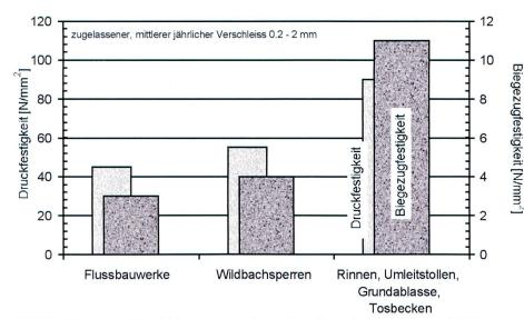
Bild 11. Allgemeine Empfehlungen zu notwendigen Betonfestigkeiten nach 28 Tagen in Abhängigkeit von der Art des Bauteils.
