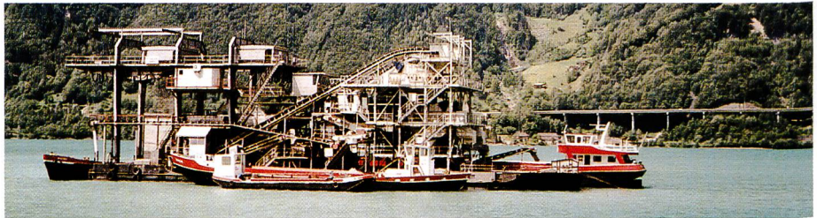
Bild 1. Die seit über 35 Jahren im Vierwaldstättersee im Einsatz stehende schwimmende Greiferbaggeranlage, die eine Wasserverdrängung von 1000 t aufweist, ist modernisiert worden. Damit kann eine umweltschonende Kiesgewinnung in unmittelbarer Nähe des neuen Seeschüttungsprojekts bei Flüelen gewährleistet werden (Foto: C. Mayer).
