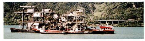
Bild 1. Die seit über 35 Jahren im Vierwaldstättersee im Einsatz stehende schwimmende Greiferbaggeranlage, die eine Wasserverdrängung von 1000 t aufweist, ist modernisiert worden. Damit kann eine umweltschonende Kiesgewinnung in unmittelbarer Nähe des neuen Seeschüttungsprojekts bei Flüelen gewährleistet werden (Foto: C. Mayer).
