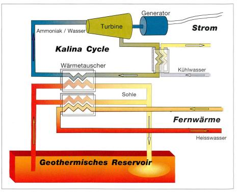
Bild 2. Prinzip des Hot-Dry-Rock-Verfahrens zur Wärme- und Stromgewinnung.
