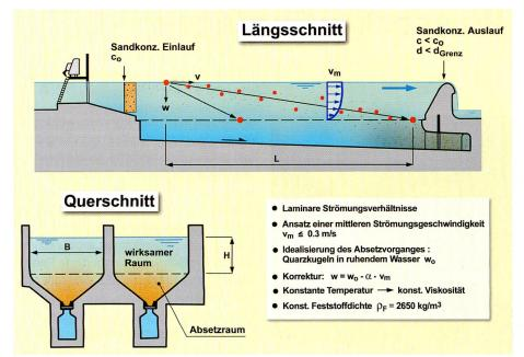
Bild 2. Idealisierter Längs- und Querschnitt eines Langsandfangs.
