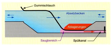
Bild 7. Vertikales Sandabzugssystem «Serpent Sediment Sluicing System».
