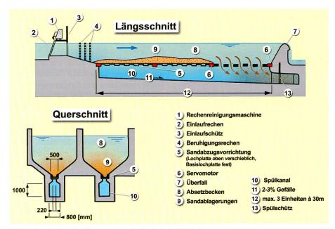
Bild 6. Vertikales Spülsystem nach Bieri. Seit 1950 eingesetzt.
