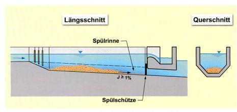
Bild 5. Horizontales Spülsystem nach Büchi. Seit 1910 eingesetzt.
