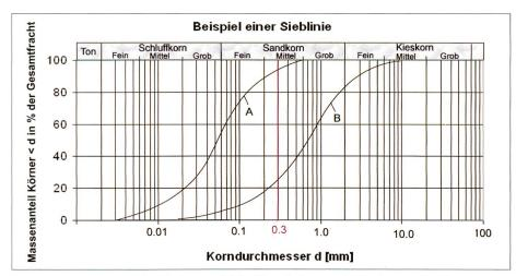
Bild 3. Beispiel einer feinkörnigeren (Linie A) und einer grobkörnigeren Sieblinie (Linie B).
