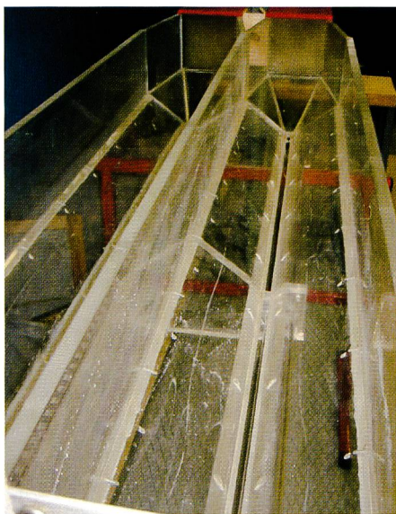
Bild 1. Entsanderanlage mit zwei Becken im Modell: links konventioneller Abzug, rechts Becken mit Sandabzug System HSR.
