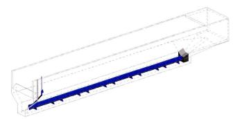
Bild 2. Gesamtansicht des patentierten Sandabzugsystems HSR: modular zusammengesetzte Komponenten, links Notspüleinrichtung, rechts einbetoniertes Anschlussrohr.
