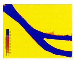
Bild 5. Berechnete Abflusstiefen bei einem Abfluss von Q<sub>Aare</sub> = 900 m³/s. Entlang des Oberwasserkanals zum Kraftwerk treten vereinzelte Ausuferungen auf.
