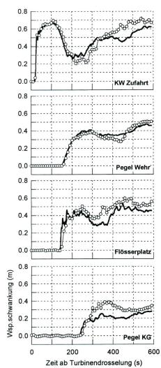
Bild 4. Vergleich der gemessenen und der berechneten Wasserspiegelschwankungen bei ausgewählten Messpunkten für den Lastfall Notschluss. Die ausgezogene Linie entspricht den gemessenen und die Punkte den berechneten Werten.
