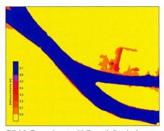
Bild 6. Berechnete Abflusstiefen bei einem Abfluss von Q<sub>Aare</sub> = 1000 m³/s. Entlang des Oberwasserkanals zum Kraftwerk treten weitgehende Ausuferungen auf.
