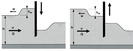
Bild 2. a) Absperrschwall und b) Entnahmesunk.
