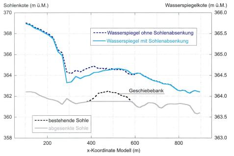
Bild 16. Längsschnitt der Wasserspiegel- und Sohlenkoten der Aare, mit und ohne Sohlenabsenkung bei der Verzweigung. Die Verengung bei der Kettenbrücke (x = 250 m) bewirkt einen Aufstau oberhalb und eine Senkkurve infolge der Querschnittsaufweitung unterhalb. Die Senkkurve wird anschliessend vom Rückstau aus dem Oberwasserkanal des Kraftwerks überlagert.
