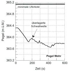
Bild 11. Hydrographen für Pegel OW und Pegel Wehr, nach einem Notschluss bei  $Q_{Aare} = 500 \text{ m}^3/\text{s}$  mit Entnahmesunk. Der Notschluss erfolgt bei 0 s.
