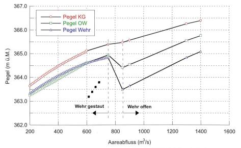
Bild 7. Berechnete Pegel-Abfluss-Beziehungen für das KW Rüchlig mit Kraftwerkbetrieb, falls bei 850 m<sup>3</sup>/s das Wehr voll geöffnet ist.
