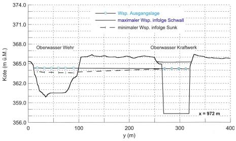
Bild 12. Wasserspiegellagen vor und nach dem Schwall/Sunk beim Profil x = 972 m,  $Q_{Aare} = 500$  m<sup>3</sup>/s. Blick gegen die Fliessrichtung.
