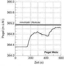
Bild 8. Hydrographen für die Messpunkte KW Zufahrt und Pegel Wehr nach einem Notschluss bei  $Q_{Aare} = 500 \text{ m}^3/\text{s}$ . Der Notschluss erfolgt bei 0 s.
