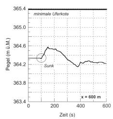
Bild 13. Zusammentreffen von Sunk und Schwall bei  $x = 600 \, \text{m}$ .
