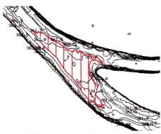
Bild 15. Abgesenkte Sohlentopografie im Bereich der Geschiebebank bei der Verzweigung zum Oberwasserkanal des Kraftwerks und zum Oberwasser des Wehrs.
