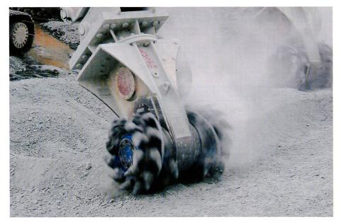
Bild 3. Detail einer Felsfräse.
