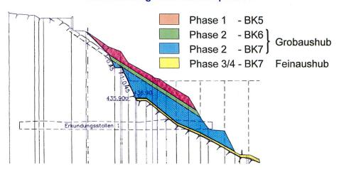
Bild 1. Aushubphasen für die Talsperrengründung.
