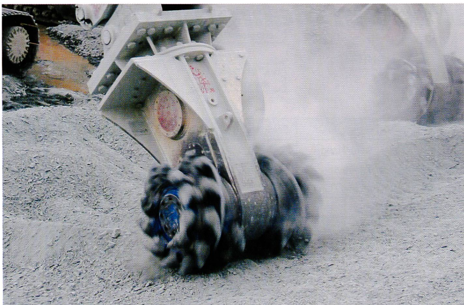
Bild 3. Detail einer Felsfräse.
