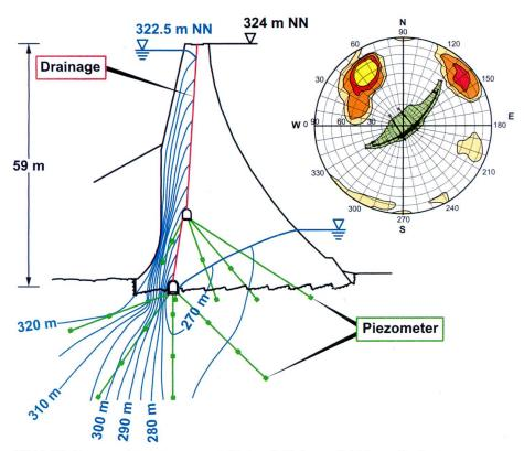
Bild 2. Kluftwasserdruckmessungen (Potenziallinien, grün) bis zur Drainage.
