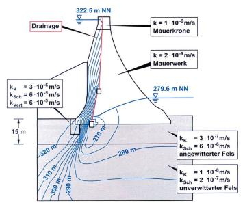
Bild 3. Sickerströmungsberechnung (Potenziallinien) - ohne Riss.
