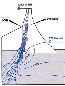
Bild 4. Sickerströmungsberechnung (Potenziallinien) - mit Riss.
