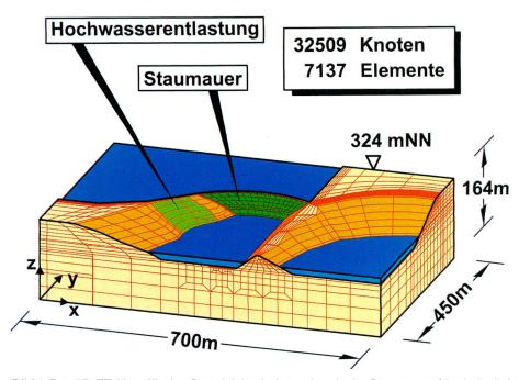
Bild 1. Das 3D-FE-Netz für den Standsicherheitsnachweis der Staumauer (dunkelgrün) und modellierter Felsnase (links) sowie Hochwasserentlastung (rechts).
