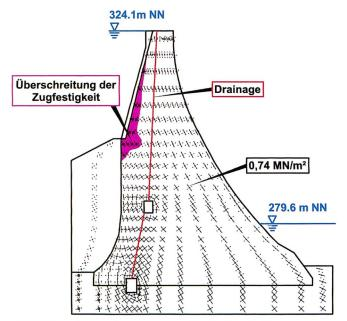
Bild 5. Hauptnormalspannungen für den Lastfall 3a (Überschreitung der Zugfestigkeit) – ohne Riss.
