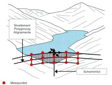
Bild 3. Staumauer. Deformationsmessungen in einem orthogonalen Netz.
