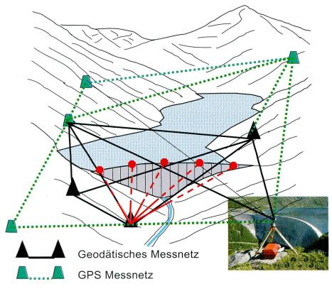
Bild 6. Schema des Netzes für die geodätische Messung.
