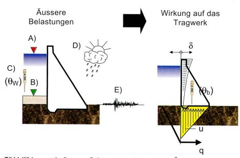
Bild 1. Wirkungen der äusseren Belastungen auf das Bauwerk. Äussere Belastungen: A) Wasserdruck; B) Druck aus Sedimenten; C) Wassertemperatur; D) klimatische Verhältnisse (Lufttemperatur, Regen, Schnee); E) Belastung durch Erdbeben. Wirkungen der Lasten: Verformungen ( $\delta$ ); Betontemperaturen ( $\theta$ <sub>b</sub>); Durchsickerungen ( $\theta$ ); Auftrieb ( $\theta$ ) und Porenwasserdrücke.
