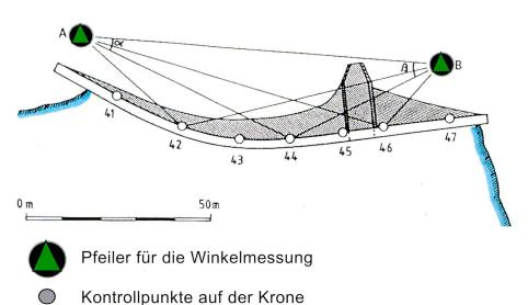
Bild 5. Damm. Deformationsmessung mittels Winkel- und Distanzmessung.
