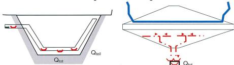
Bild 7. Staumauer und Damm. Sickerwassermessungen Q<sub>total</sub> und Q<sub>teil</sub>.
