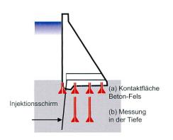
Bild 8. Staumauer. Auftriebsmessungen in der Kontaktfläche Beton-Fels (a) und in der Tiefe (b).
