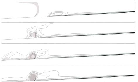
Bild 16. Simulation eines durch einen 45° aufwärts gerichteten Wasserstrahl fliessenden Trübestroms in Zeitintervallen von 20 s. Die Linien gleicher Sedimentkonzentration sind mit einem Intervall von Dr = 0,1 g/l dargestellt, wobei die oberste Linie einer minimalen Konzentration von 0,1 g/l entspricht (Versuch E01).
