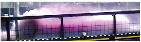
Bild 15. Hydraulischer Modellversuch mit 45° aufwärts gerichtetem Wasserstrahlschleier (Versuch E01).
