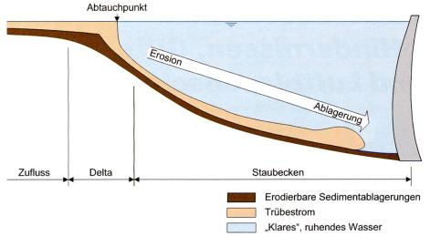
Bild 1. Schematische Darstellung eines Trübestroms in einem Stausee.
