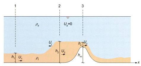
Bild 3. Durch Hindernis teilweise gebremster Trübestrom.
