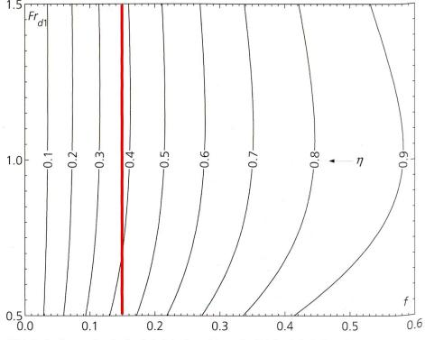
Bild 10. Sedimentdurchgängigkeit h eines Gitters in Abhängigkeit der wirksamen Porosität f und der Froudezahl des ankommenden Trübestromes Fr<sub>d1</sub>.
