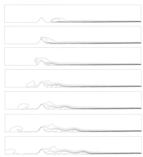
Bild 8. Simulation eines über ein Hindernis fliessenden Trübestroms in Zeitintervallen von 20 s. Die Linien gleicher Sedimentkonzentration sind mit einem Intervall von  $\Delta \rho = 0.1$  g/l dargestellt, wobei die oberste Linie einer minimalen Konzentration von 0,1 g/l entspricht (Versuch B03).
