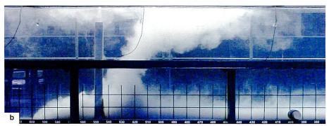
Bild 17. Hydraulische Modellversuche mit einem Luftblasenschleier. a) Luftblasenschleier mit Auftriebsfluss rund 300-mal grösser als Auftriebsfluss des Trübestroms (Versuch F01).
