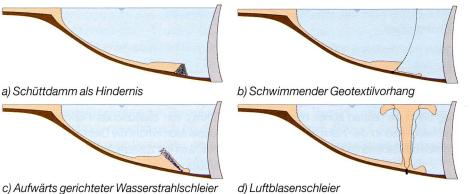
Bild 2. Technische Massnahmen zur Beherrschung von Trübeströmen in einem Stausee.
