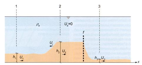
Bild 9. Durch Gitter oder Geotextil teilweise gebremster Trübestrom.
