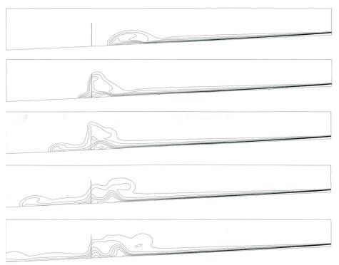
Bild 13. Simulation eines durch ein Gitter fliessenden Trübestroms in Zeitintervallen von 20 s. Die Linien gleicher Sedimentkonzentration sind mit einem Intervall von Dr = 0,1 g/l dargestellt, wobei die oberste Linie einer minimalen Konzentration von 0,1 g/l entspricht (Versuch CO3).
