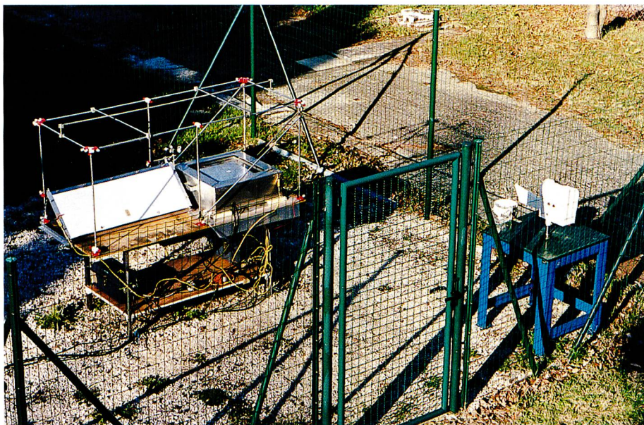
Bild 6. Versuchseinrichtung eines Taukollektors in Grenoble (1997) mit Zusatz-ausrüstung – Plexiglas, Waage, Manometer usw. – zur Bestimmung der optimalen Ausbeutung und der chemischen Zusammensetzung des Tauwassers. Foto: D. Beysens, Archiv OPUR.
