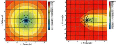
Bild 4. Einfluss der Grundwasserströmung auf die Temperaturverteilung in der Umgebung einer Erdwärmesonde. Links ohne, rechts mit Grundwasserströmung [aus Schlussbericht].
