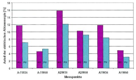
Bild 2. Anteil der zum Abtauen benötigten elektrischen Energie am elektrischen Energieaufwand für den Heizbetrieb ohne Berücksichtigung der Abtauung durch freie Konvektion bei höheren Lufttemperaturen. Mittelwerte der ausgemessenen Wärmepumpen. HG = Heissgasabtauung, PU = Abtauung durch Prozessumkehr [aus Schlussbericht].
